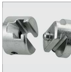
Муфта с Т-образным пазом, скосы облегчают сцепление
