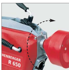
Приводной рычаг переставляется
