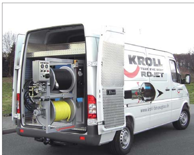
Комфортное исполнение - поворотный держатель для барабана
