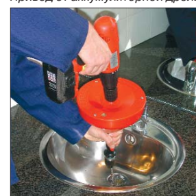
Привод от аккумуляторной дрели
